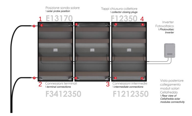
Collegamento con la centrale termica \ connection with the boiler room
